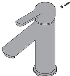
3 **Soltar el tornillo que sujeta la maneta con el cartucho monomando con la llave allen** · Remove the screw that holds the handle with the mixer cartridge with the Allen key · *Lâcher la vis qui fixe la cartouche à la manette avec la clef allen fournie.*
